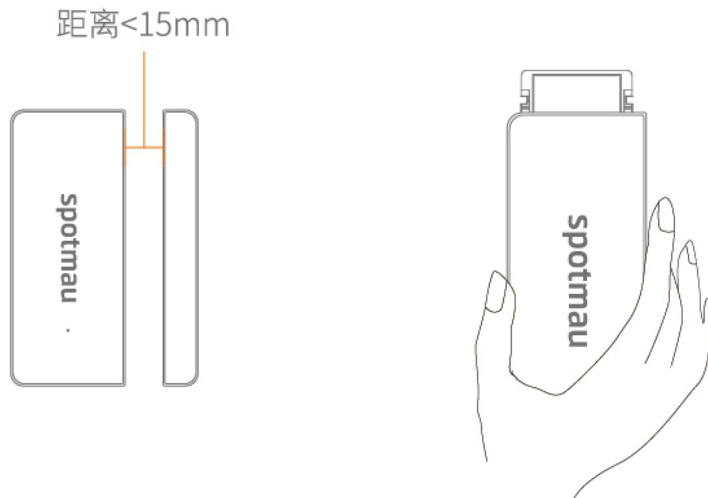
**3** 将门窗磁主体挂入安装底座，安装完成。
