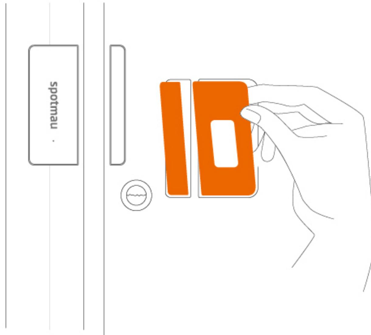
如图门窗磁主体应安装在门框等固定位置, 磁体可安装在门板等活动位置。
