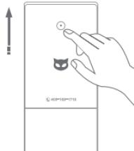
**第一步：**拧开电池盖螺丝，往上推电池后盖，取下电池后盖；
